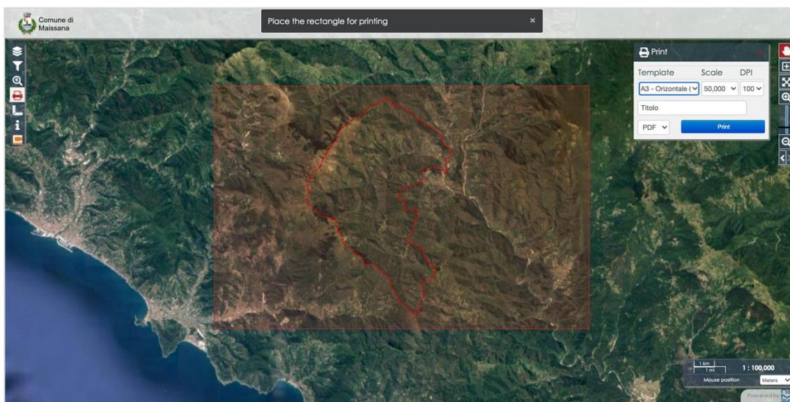
Avviato il pannello nella mappa apparirà un rettangolo rosso trasparente delle dimensioni della porzione di mappa che verrà stampata. Modificando i parametri inseriti cambieranno anche le dimensioni dell'area di stampa. A questo punto sarà possibile spostare l'area di stampa manualmente sulla mappa per centrarla nell'area interessata.
