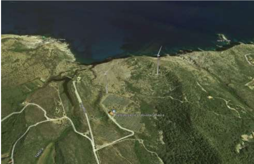
Figura 25 Rendering della centrale di Nasca qualora si decidesse di installare fino a 2MW di fotovoltaico e 2 turbine eoliche da 2 MW ciascuna.
